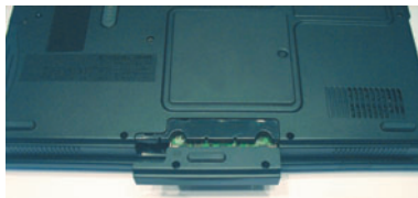
Под этой крышкой находится отсек жесткого диска
